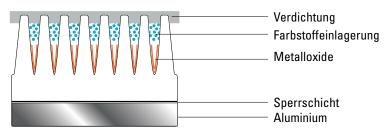
Nach der Farbeinlagerung werden die Poren mit amorphem Aluminiumoxidhydrat geschlossen. Diese Verdichtung ist der abschließende Schritt des Eloxalverfahrens, somit wird das Aluminium vor Witterungs-/Korrosionseinflüssen geschützt. Der Eloxierund Färbevorgang ist somit abgeschlossen. Die Oberfläche erscheint dadurch hoch dekorativ.
