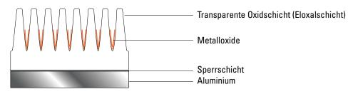
Die transparente Eloxalschicht lässt sich mit Hilfe einer Metallsalzlösung (farbige Metalloxide) elektrolytisch einfärben. Die Farbwirkung entsteht nicht auf der Oberfläche der Eloxalschicht, sondern geschützt am Porengrund.
