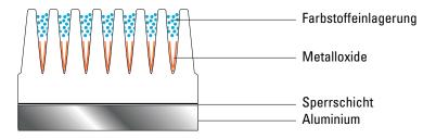
Durch die Kombination der elekrolytischen Färbung und der adsorptiven Tauchfärbung lassen sich zusätzlich Farbtöne (Blau, Rot, Schwarz, Gold etc.) in verschiedenen Helligkeitsstufen herstellen. Die adsorptiven Farben lagern sich im Gegensatz zu den Metalloxiden eher an den Porenwandungen an. Die Farbwirkung ist ausgesprochen lebendig und metallisch leuchtend.
